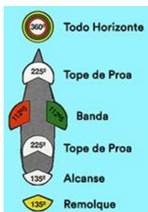
**Luces de bandas:** Estas luces rojas y verdes se llaman luces de bandas (o luces combinadas) porque son visibles para otra embarcación que se aproxima por el costado o de vuelta encontrada. La luz roja indica la banda de babor (izquierda) de una embarcación; la luz verde indica la banda de estribor (derecha) de una embarcación.
